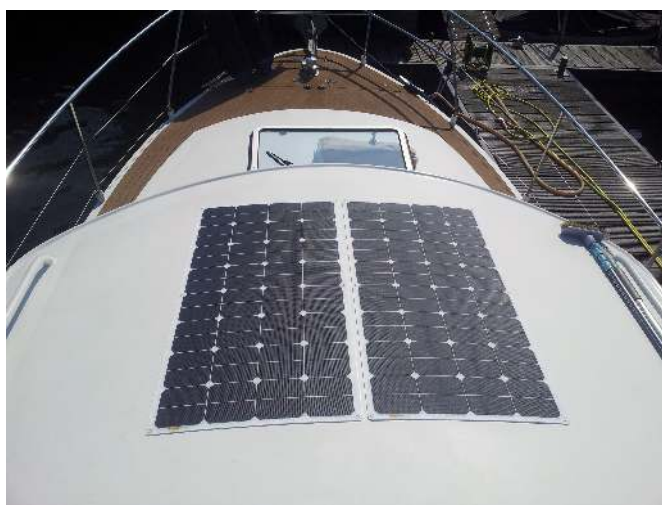
Sunbeam Flush panelen geïnstalleerd met kabel direct naar beneden doorgevoerd
