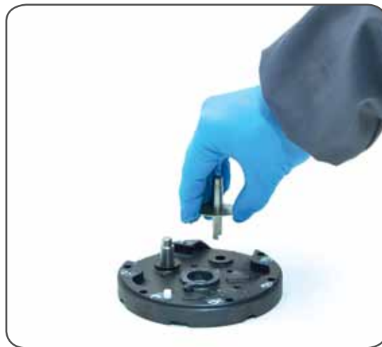
15. Remove washer n°9 and pin n°8
