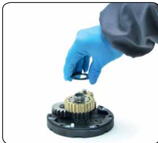
9. Remove the washer n°12
