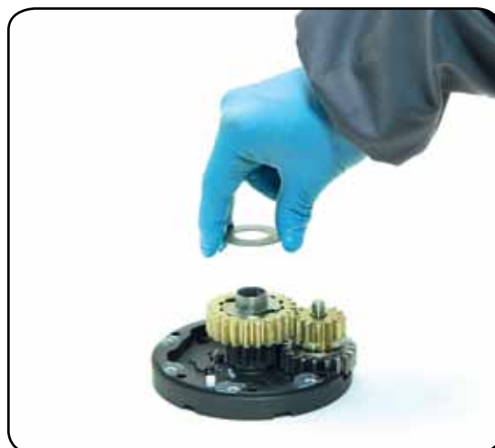
12. Remove the washer n°11
